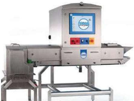
Adapté au vrac, le scanner X5 Bulkflow de Loma s'alimente par le haut. Le produit est étalé au centre de la bande.
